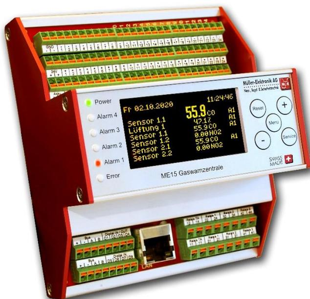
Die Gaswarnzentrale ME 15 ist eine Gasüberwachungs- und Auswerteinheit für eine Vielzahl von Gasverbindungen. Je nach Ausführung können mit der Gaswarnzentrale bis zu 200 Gassensoren verwaltet werden.
